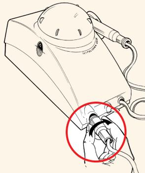
Плотно затяните гайку коннектора по резьбе, чтобы предотвратить утечки воздуха и воды.
