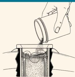
Переполнение стакана приводит к закупорке системы прибора.
