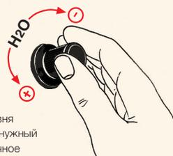
Начните с нижнего уровня и постепенно получите нужный поток воды. Недостаточное количество воды создаёт брызгающий, прерывистый поток. Излишнее количество воды приводит к неэффективной работе прибора и повышенному распылению вокруг рабочего места. Используйте только достаточное количество воды для постоянства потока.
